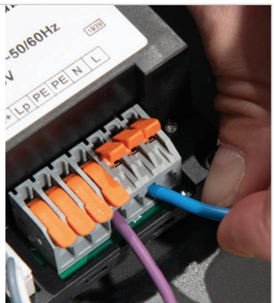
Con las palancas levantadas, es sencillo introducir los cables en la posición correcta indicada. Luego, las palancas se vuelven a bajar para fijar la conexión eléctrica.
