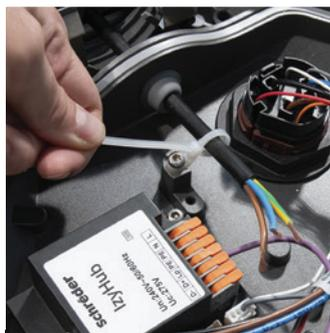
Para fijar el cable principal dentro de la luminaria, se utiliza una brida de plástico o una abrazadera de metal.
