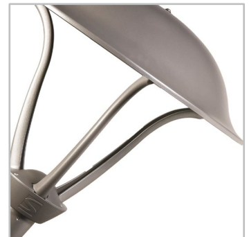
ISLA LED está diseñada para montaje deslizante sobre una espiga de Ø60 o Ø76 mm.
