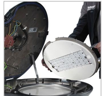
FLEXIA POEME incorpora un seccionador eléctrico instantáneo en la apertura y un motor LED completo desmontable sin herramientas.
