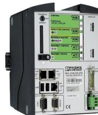
Desarrollada conjuntamente por Schréder y Phoenix Contact, Advanced Tunnel System 4 (ATS 4) se diseñó para controlar cada punto de iluminación o grupos de luminarias y adaptar perfectamente el nivel de iluminación a las condiciones del túnel, supervisar el consumo de potencia y notificar las horas de encendido o cualquier fallo, facilitando así el mantenimiento. El sistema incluye una función de puesta en marcha automática y permite adaptar los escenarios remotamente en cualquier momento.
