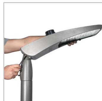
El ángulo de inclinación se puede regular in situ tanto para la configuración post-top (0 a +15°) como para la de entrada lateral (0 a +15°).
