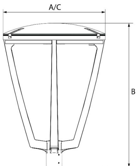
FLEXIA BRASO | Montaje deslizante Ø60 mm
