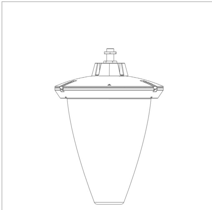
FLEXIA POEME | Suspendingo con junta de horquilla de fijación de cierre de 1" gas (S5)
