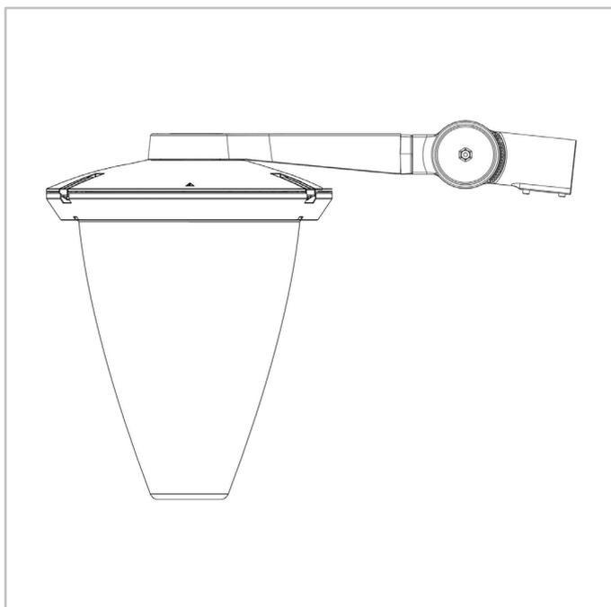
FLEXIA POEME | Junta de unión lateral penetrante Ø48mm (A5)
