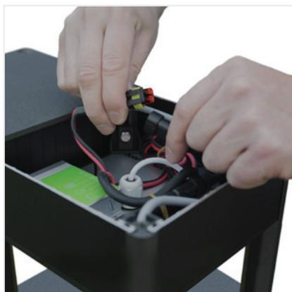
Conectores codificados sin herramientas para una rápida instalación *plug and play*.
